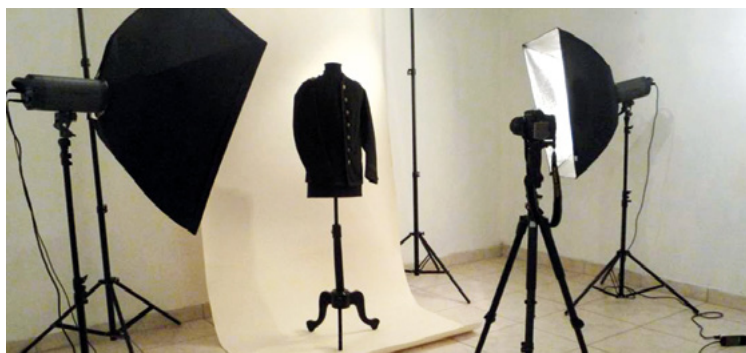
Fig. 33. Utilización de fondo sinfín e iluminación durante el proceso de documentación visual con fotografía profesional.
